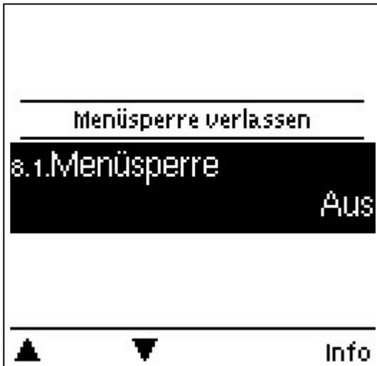
Durch aktivierte Menüsperr können die eingestellten Werte gegen unbeabsichtigtes Verstellen gesichert werden.
