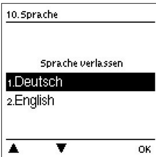
Zur Wahl der Menüsprache. Bei der ersten Inbetriebnahme und bei längerer Spannungsunterbrechung erfolgt die Abfrage automatisch. Die wählbaren Sprachen können sich je nach Geräteausführung unterscheiden! Die Sprachwahl ist nicht in jeder Geräteausführung vorhanden!
